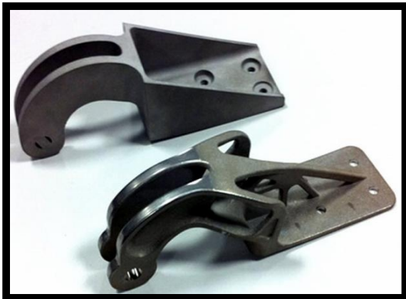
Оптимизированная петля (внизу) самолета выполненная по технологии 3D-печати и петля по старой технологии
